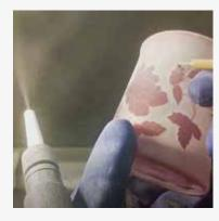
空気圧で砂(アルミナ)を吹き付けてガラスを彫るサンドブラストという 技法を使って、様々なデザインを彫刻加工しています。
